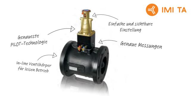
TA-PILOT ist ein sehr leistungsfähiger Inline Differenzdruckregler mit außergewöhnlicher Genauigkeit. Er sorgt für stabile Differenzdrücke, um in Regelkreisen eine hohe Authorität der Regelventile zu garantieren. Zusätzlich werden Geräusche vermieden und die Einregulierungsarbeit vereinfacht. TA-PILOT ist für den Einbau im Rücklauf vorgesehen.
